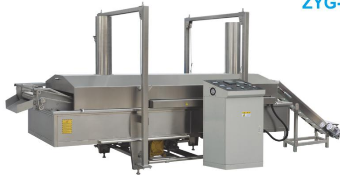
LXYG-D 自动连续油炸线 Continuous Frying Line
